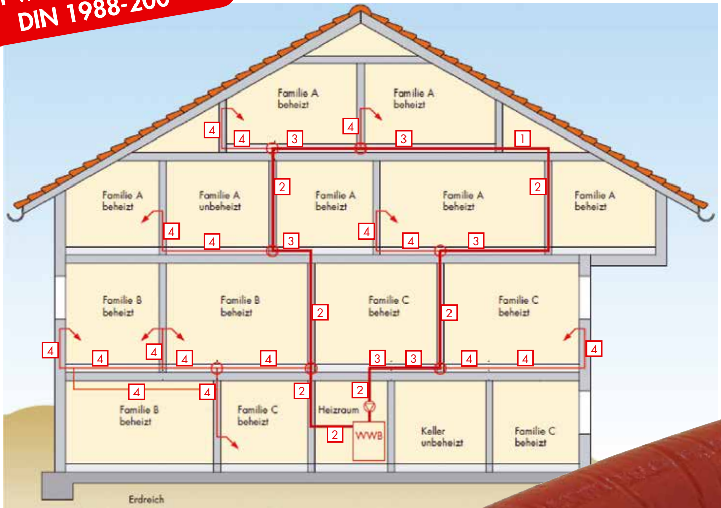
Dämmungsbeispiele für Warmwasserleitungen nach DIN 1988-200
