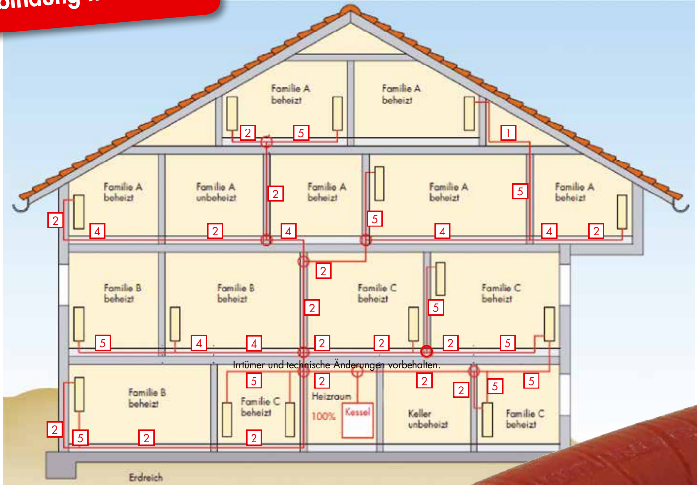
Dämmungsbeispiele für Heizungsanbindeleitungen nach EnEV
