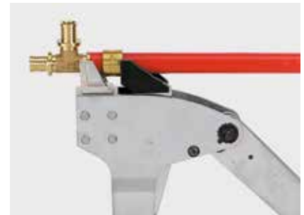
Manueller Aufschiebevorgang mit KSZ.
