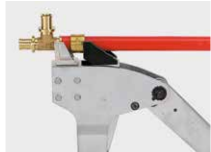
Manueller Aufschiebevorgang mit KSZ.
