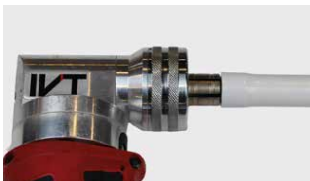
Aufweitvorgang mit Akku-Kompaktaufweiter AKA
