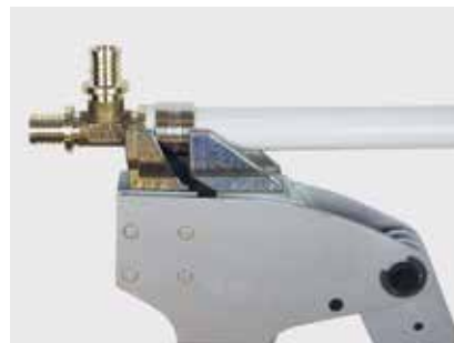
Manueller Aufschiebevorgang mit Kniehebelschiebezange KSZ.
