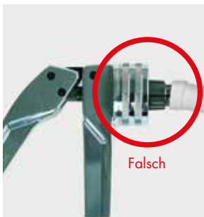
Aufweiten unter Biegespannung
