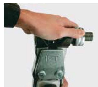
Aufweitvorgang mit Aufsatz A und Aufweitbit
